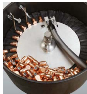
Podavač střel do pistolí nefunguje s olověnými nebo pokovenými střelami.
